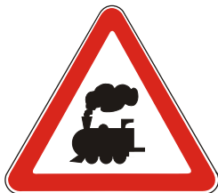
Cruce Ferroviario P 1
