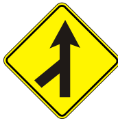
Incorporación de Tránsito Lateral P 22
