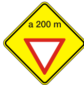
Proximidad de Señal Restrictiva (Paso) P 33
